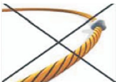
胶水固定安装 (容易损伤线缆)
